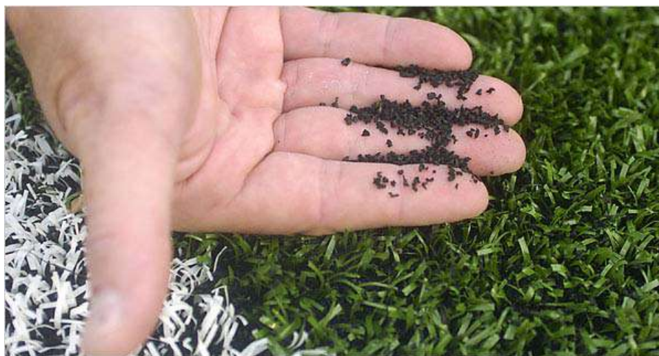
Figure 2. Photographie des matériaux d'un gazon synthétique avec granulats SBRr
